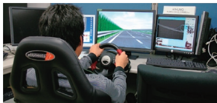
DS+交通シミュレーション環境を用いたドライバモデル解析と運転行動評価
