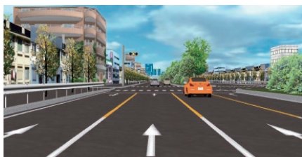
黄信号時のドライバー挙動を分析するジレンマ信号制御の実験
