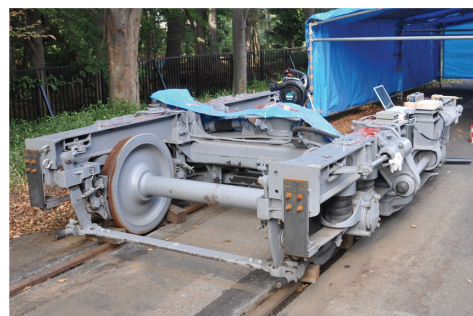
ICAによる鉄道台車の振動解析
