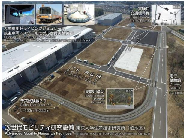
柏地区の北側に広がるITS R&R 実験フィールド（鉄道試験線、走行試験走路、交通信号機、踏切）や、大型車用ドライビングシミュレータ等は、大学ではあまり見られない実スケールの実験が可能な研究設備です。自動運転・運転支援や、車両・レール系の摩擦・接触、交通制御をはじめとした様々な研究に活用され、共同研究等を通じて外部の企業・機関にも多く利用されています。
