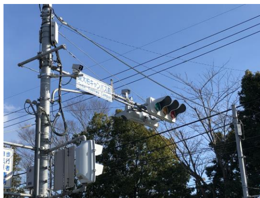
自動運転バスと連携する 公道上に設置されたセンサ (柏 ITS 推進協議会実証実験)
