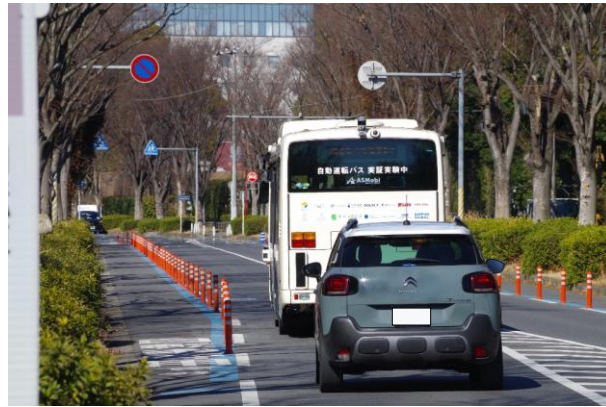
走行空間実証実験において、ラバーポールを設置し、 路上駐車抑制が自動運転バスの手動介入に与える効果などを検証
